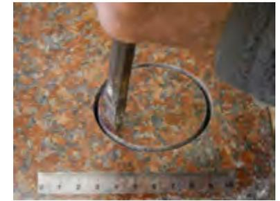
Abb. 17-18 Erster und zweiter Abschlag am Bohrkern.
