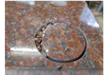
Abb. 21-22 Hineintreiben der Abschlüge in den Spalt als Keile zum abtrennen des Bohrkerns und rechts: getrennter und nach rechts gekippter Bohrkern.
