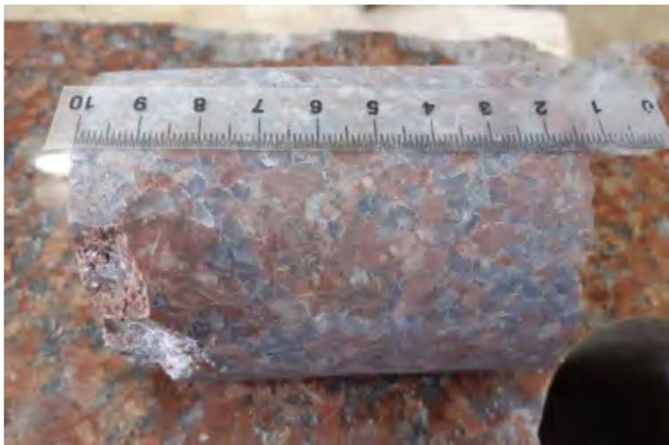
Abb. 15-16 Bohrloch, 90 mm tief, vor dem ersten Abschlag am Bohrkern.
