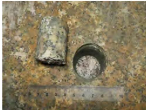
Abb. 12 Blick auf den Boden des Bohrlochs.
