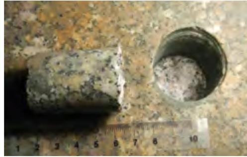
Abb. 9 Abgetrennter Bohrkern.
