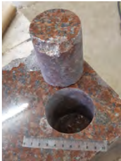
Abb. 23 Bohrkern mit drei Abschlügen an der Oberkante, wie beim altägyptischen Original.
