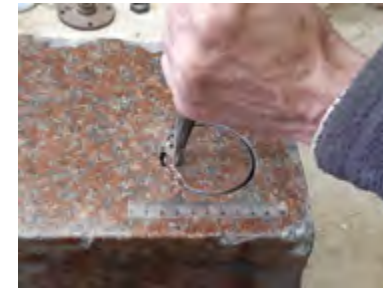
Abb. 19-20 Dritter Abschlag am Bohrkern.
