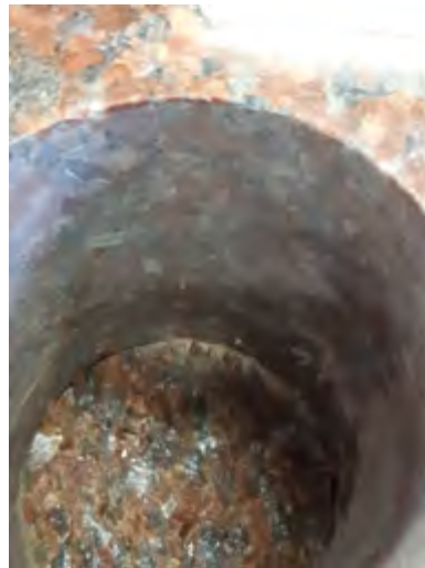
Abb. 24 Bohrloch mit etwa 1 mm schmaler Schleifrinne am Rand des Bohrlochbodens, ähnlich den Bohrlöchern an altägyptischen Architekturteilen.
