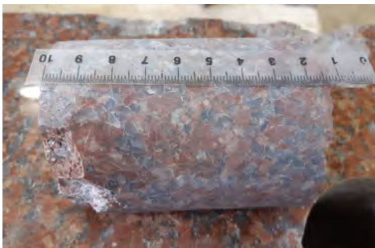
Abb. 24 Bohrloch mit etwa 1 mm schmaler Schleifrinne am Rand des Bohrlochbodens, ähnlich den Bohrlöchern an altägyptischen Architekturteilen.
