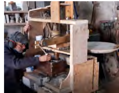
Abb. 13-14 Konstruktion des zweiten Bohrwerkzeugs mit größerem Bohrdurchmesser (68 mm).
