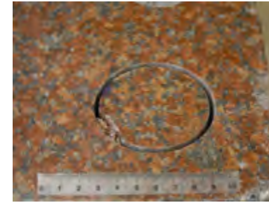
Abb. 17-18 Erster und zweiter Abschlag am Bohrkern.
