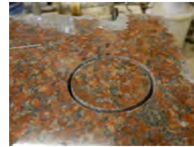
Abb. 15-16 Bohrloch, 90 mm tief, vor dem ersten Abschlag am Bohrkern.
