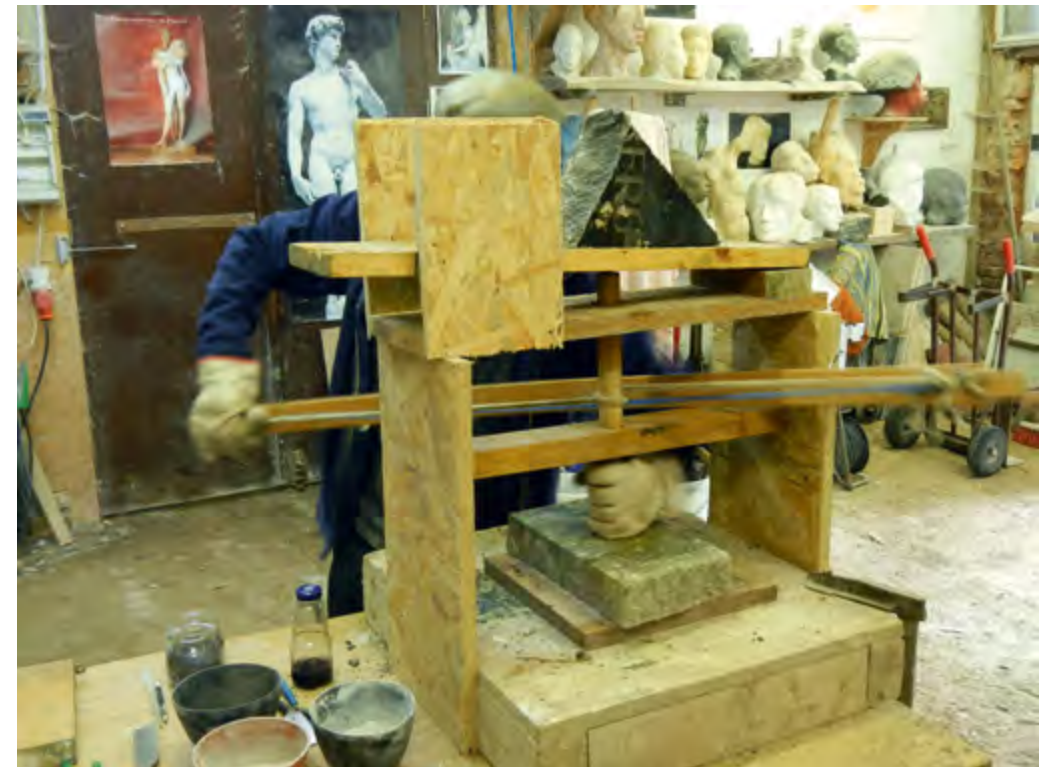
Abb. 7 Dieter Homeyer in seiner Werkstatt beim Betreiben der handbetriebenen Kernbohrmaschine mit Kupfer-Bohrkrone zum Bohren von Granit.
