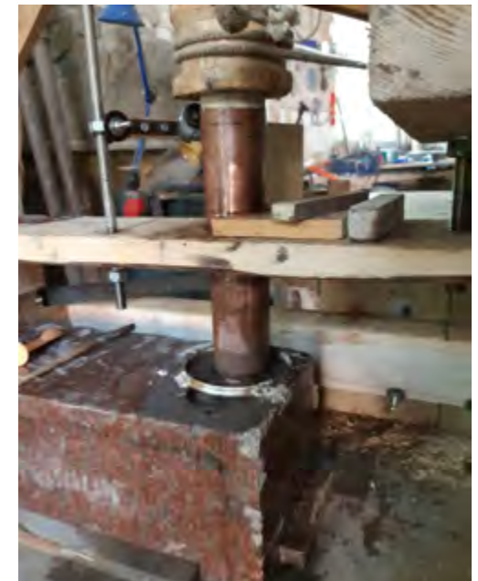
Abb. 13-14 Konstruktion des zweiten Bohrwerkzeugs mit größerem Bohrdurchmesser (68 mm).
