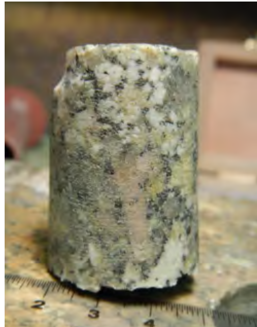
Abb. 10 Bohrkern aus der Apparatur von Dieter Homeyer mit den typischen Riefen an der Wand des Zylinders und mit der typischen Verbreiterung am unteren Ende, wie beim altägyptischen Original.
