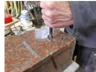
Abb. 21-22 Hineintreiben der Abschlüge in den Spalt als Keile zum abtrennen des Bohrkerns und rechts: getrennter und nach rechts gekippter Bohrkern.
